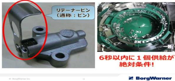
5号機で組立が完了したTensionerがこちらの写真になります。今回の問題は、赤丸箇所「リテーナーピン」(通称: ピン)と呼ばれる構成部品を供給している供給機で発生している問題です。供給機ですが、振動とエアの力で狙いの姿勢の部品のみをレールに並べていきます。サイクルタイム6秒以内にピンを1個供給できないと、ピン供給遅延トラブルとなります。
