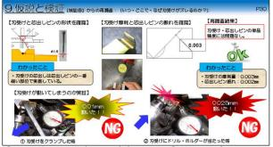
【いつ・どこで・なぜ刃受けがズレるのか?】 芯出しはピンの一番細い部位を使用しているため、芯出し時にたわんでしまう可能性がある。次に刃受けと芯出しピンの摩耗状態を確認した。 使用済み刃受けの摩耗量を測定した結果、刃受けの摩耗量は $3\mu$ 、芯出しピンの振れは $2\mu$ で単品精度には問題はなかった。
