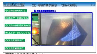
再研磨の作業手順に移ります。 再研磨作業は3カ所の研磨になります。先ず刃先の研磨です。 ①の刃物を取り付けるから始まり、⑥の刃先の確認までが刃 先の研磨になります。【動画再生】:動画をご覧ください。
