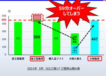
ターゲットである"大物入替工程"の作業は、14受入での大物入替リフトは136分。07受入での素材供給は140分掛かっていることが分かり、作業工数の低い"後工程集荷"に素材供給を大物集荷に大物入替リフトを移管できないかと考えました。大物入替リフトはそのまま"大物集荷"に移管できるが素材供給をそのまま"後工程集荷"に移管すると59分オーバーする為、メンバー全員で素材供給を調査することにしました。
