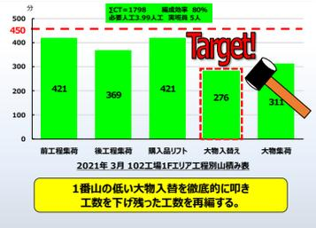
編成効率を上げる為に、1階エリアの一番山の低い"大物入替工程"を徹底的に叩き工数を下げ、残った工数を再編し5人から4人へ省人出来るよう【大物入替工程一人工追求による省人】に取り組んでいます。
