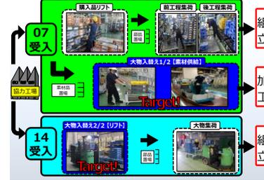
工程の概要 07受入では、納入部品を仕分け・投入する"購入品リフト"シートから部品を集荷する"前工程集荷"と"後工程集荷"、歩行又はユニットにて機械課へ素材を供給し、14受入に行きピストン・スワッシュをリフトで入替をする"大物入替工程"組立ラインに使用するピストン・スワッシュを集荷する"大物集荷"があります。
