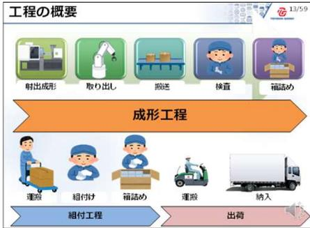
工程の概要です。①射出成形した製品を自動取り出し、検査、箱詰めを行って自工程での完成となります。②射出成形の流れとして、材料フレコンに入っている材料ペレットを乾燥し射出成形機に送り、成形品を作る流れになります。
