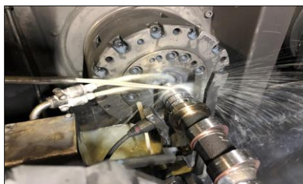
配管を設置し、チャックとワークを洗浄
