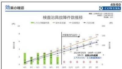
次に効果の確認に移ります。対策後の9月22日からは、エアバックハーネスの断線故障件数が0件となり検査治具の故障件数全体の18%低減できました。
