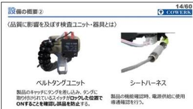
検査ユニットには、製品側のキャッチの誤品防止として製品のキャッチにタングを差し込みタングに取り付けられているスイッチがロックした位置でONすることを確認するベルトタングや、機能確認時電源を供給し、導通確認を行うシートハーネスなどがあります。
