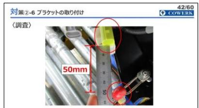
接触しないようにする為、製品側コネクタ部からトグルクランプまでの距離を計測したところ50mm以内で製作しなければならないということがわかりました。
