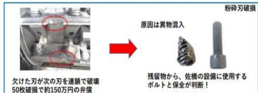
調査の結果 保護キャップ容器に金属が混入していた！
