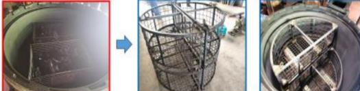
トライ中の容器 専用の加硫籠を作製 投入量62%UPに成功！
