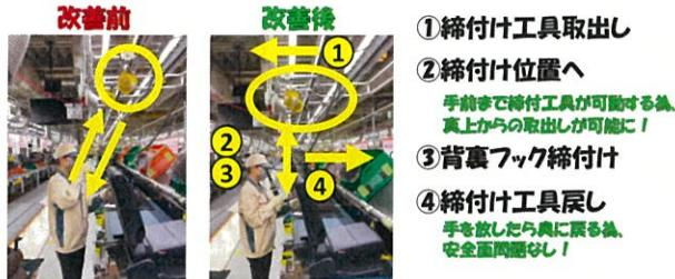
改善前と改善後の比較をしてみると、改善前は斜め前の遠くから引つ張っていた締付け工具を改善後は架台についているレールの動きで締付け工具を頭上へ移動させ、真下の背裏フック締付け位置までに持って行くことが出来るようになりました。
