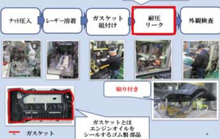
ガスケットとは、エンジンオイルをシールするゴム製の部品です。ライン製品の流れは、ナット圧入から外観検査となり、ガスケットの張り付きが発生している工程は「耐圧リーク工程」となります。
