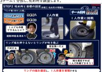
リング付けでは、一人作業に挑戦、 結果はリングが端から吹き飛んでしまい作業不可。 しかし、リング端を固定すれば1人作業できそうだと、 ひらめきました。
