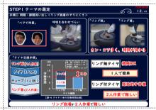
リング脱着のやり難さとしてペアでの作業は呼吸がわせづらく、 カンコツが多い為、機械で作業可能なリング無タイヤと比較すると リング付タイヤ交換は、リング脱着が2人作業で難しい作業です。
