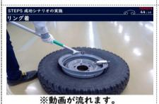
①リング端をトグルクランプで押さえる。②缶切り工具をリングへセット。 ③工具でリングを下げる。缶切り同様、工具を進めて、セットし、下げる。 3つの動作を繰り返し、リング付け完了。
