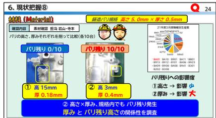
次に材料から、**鑄造規格**は高さ5mm厚さ0.5mmとなります。そこで**バリが高く薄い素材**と、**バリが低く、厚い素材**をそれぞれ削ったところ、**バリが厚い素材は規格内でもバリが残って**しまいました。この事実を共有し、**バリ取り能力**について増して、**厚みとバリ高さの関係性**を追加調査しました。
