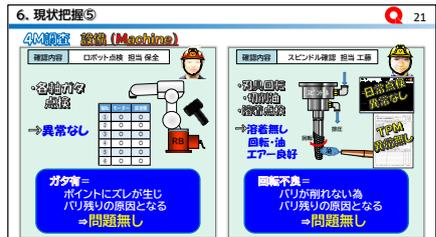
まずは設備から、ロボト軸の点検をした所、モーター減速機に問題なし。
