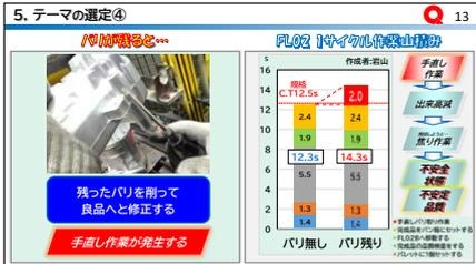
バリ残りが発生すると、良品にする為の**手直し作業**が発生してしまい、規格の1サイクル作業を越え出来高が落ちてしまいます。さらに作業員も「作業を間に合わせよう！」と焦りから、**安全・品質を怠ってしまう事**に繋がります。
