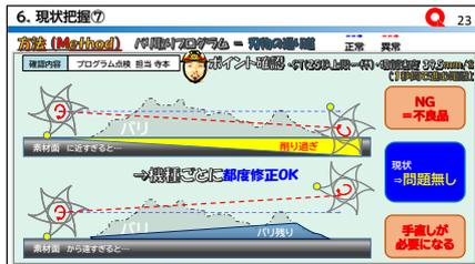
次に方法から、刃物の通り道となるポイントを確認。素材面に、刃のポイントが近過ぎると削り過ぎが発生、遠すぎると、バリ残りが発生し手直しが必要となりますが、**都度修正**されていて問題ありませんでした。
