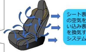
シート表皮の空気を吸い込み表面を換気するシステム
