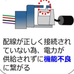
配線が正しく接続されていない為、電力が供給されずに機能不良に繋がる
