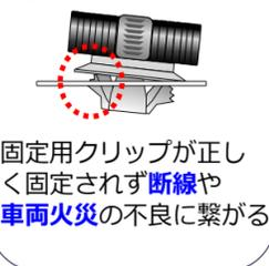
固定用クリップが正しく固定されず断線や車両火災の不良に繋がる
