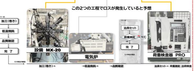
ロス時間が発生する特性は何か、現地、現物、現実での現状把握を実施することにしました。製品概要はこのようなになっておりヘッドアップディスプレイに使用されている押しパネとなります。工程詳細としては、巻き工程⇒低温焼鈍工程⇒荷重検査工程⇒出荷検査工程の順で進み、稼働が発生しているのは荷重検査工程となります。ロス巻き低温焼鈍工程と荷重検査工程で発生していると予想確認を実施しました。
