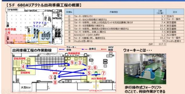
出荷準備工程の概要が、ラインからAGVで送られてきた完成品をウォーカーで降ろし、空室をウォーカーで運搬台車に載せラインへ送ります。降ろした完成品に客先かんぱんを取り付け。ウォーカーとは歩行操作式フォークリフトの事です。
