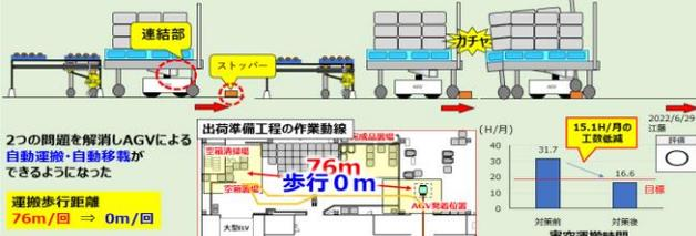
台車停車位置の床にストッパーを設置し、ピンが受けにはまってから走行する事ができるようになりました。2つの問題を解消しAGVによる「自動運搬・自動移載」ができるようになり運搬歩行距離は76mから0mにできました。
