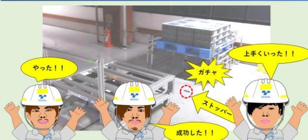
AGVが運搬台車を移載機に押し当てると、移載機の上のパレットがスライドして運搬台車に移載されます。その後運搬台車の下でAGVが進行方向を変え進みますがストッパーで、ピンをはめてから走行するようになっています。
