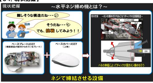
水平ネジ締め機とは 機能部品が組付けられている ベースプレートASSYと上物のベースカバーASSY をネジで締結させる設備です。 ネジ締めを行う、チャックの設備構造としてチャッ クにネジがエアーで供給され ビットでネジを押し出す際に バネの伸縮によってチャックが開き ネジ締めを行います。
