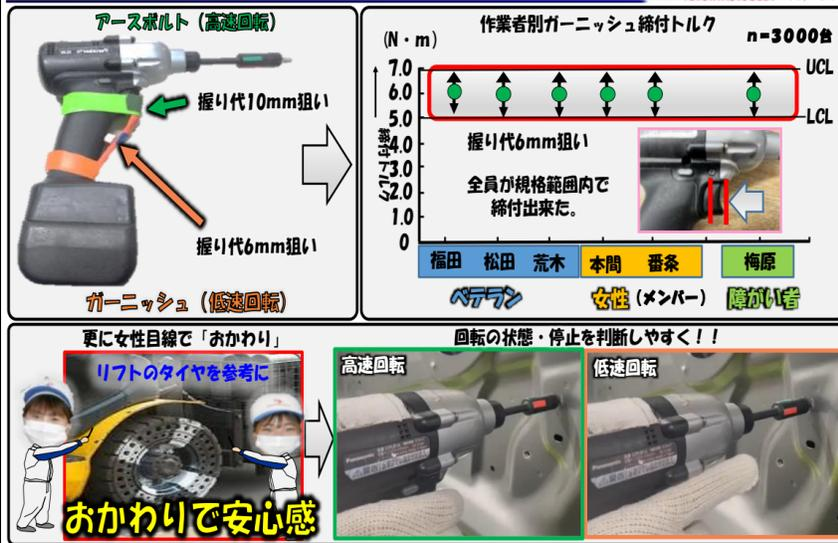
ストッパー高さ、形状、握り位置を調整しメンバーで、締付評価してみたところ梅ちゃんを含め、全員が基準トルク内で締付することができました。更に、回転の状態・停止をわかりやすくするため、リフトのタイヤのラインを参考にインパクトボックスに2色のラインを入れることで目視判断を向上することができました。
