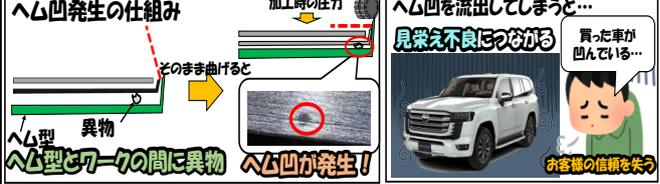
フードとはエンジンルームの蓋にあたるパーツのことを指します。ヘム機でヘミングローラーでの折り曲げ加工により、アウターパネルとインナーパネルを組み付ける過程で、ヘム型の上に異物が入りそのまま加工をすると、加工時の圧力でヘム凹が発生します。不良品はお客様の信頼を失うことにつながり、流出をさせてはいけないうものとなっています。
