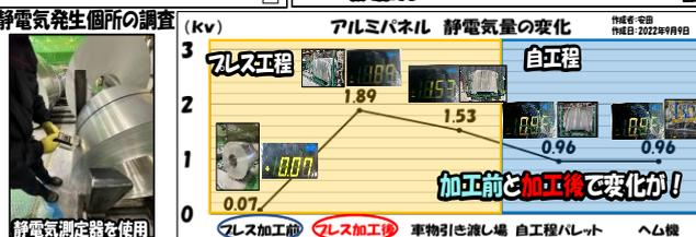
現状調査を踏まえ「付着したアルミ粉によりヘム凹が発生する」に対し、特性要因図で解析【付着したアルミ粉がヘム機内に持ち込まれる】を主要因と仮説。ある日、組長がボードに磁石を使わず掲示物を貼っていました。「なんでくっつくんですか！」と聞くと「これは静電気でくっつく静電ボードだよ！」と教えてくれました。これをヒントに静電気測定器で各工程のパネルを確認。すると、プレス加工前と加工後で静電気量に変化が。
