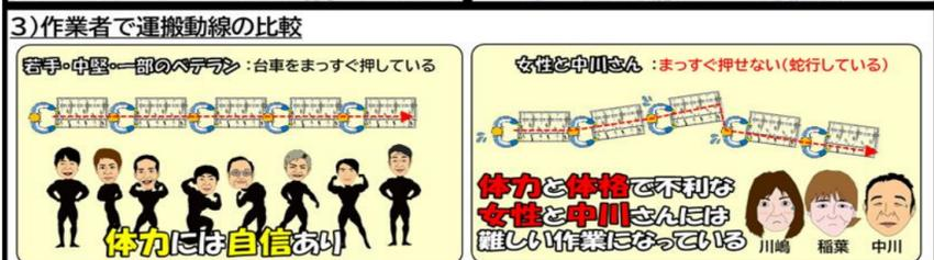
作業を観てみると、蛇行しながら押していて、スピードにもムラがあり上手に台車をコントロールできず時間がかかっていました。標準値と比較しても手押し運搬で7秒オーバーしており、作業員別で運搬動線をもみても体力・体格で不利な女性と中川さんでは難しい作業でした。
