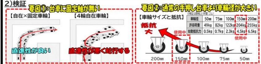
フェンダー台車のコントロールができないを解析すると、「固定軸が無い」、「車輪径が大きい」2つの要因が上がり検証。結果、すべてが自在車輪だと直進性が悪く、また、車輪径が大きくなるほど押し引きの始動抵抗が重くなり、台車コントロールに体力が必要になることが判明。
