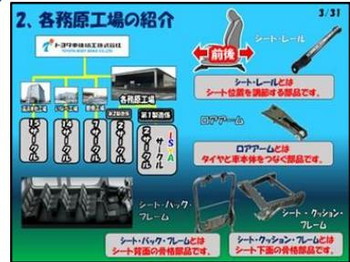
まず、はじめに職場の紹介をさせていただきます。わたしたちの職場は各務原工場、第一製造係に属しています。主な生産品は、シートの位置を調節するシート・レールと、タイヤと車本体をつなぐ部品のロアアーム、シート骨格部分のシート バック・フレーム、シート クッションフレームなどです。そして、プレス品を溶接・塗装・組付け・検査した製品を出荷しています。
