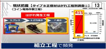
ここからタイプB正極材に絞り、工程別で調査。 はがれが発生しているのはプレス・打ち抜き・組立の工程。 さらに、はがれ発生件数を調査すると
