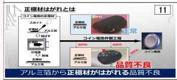
コイン電池の正極材は、ペースト状の正極材をアルミ箔に 塗工し、伸ばして、乾燥させたものです。
