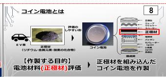
コイン電池とは、**電池材料【正極材】の評価が目的**です。 正極材は様々な原料からできている粉末のため 評価のしやすい形として、コイン電池を作製しています。
