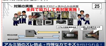
アルミ箔を挟み込むことでキズ付け時のズレを防止し 一定の重量の重しを使い、力を均等に加えられる
