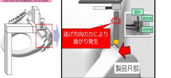
逃げ方向の力により、歪計のネジ根元部で曲がり発生
