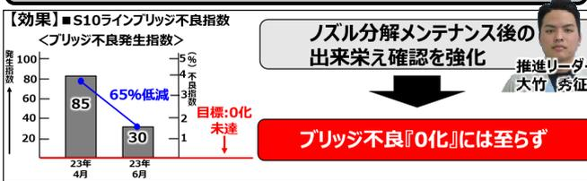
ノズル分解メンテナンス作業を大竹チームのメンバーと生技で3現確認した所、酸化物除去時にスクレーパーが背板固定ボルトに接触し、**背板ズレが発生した事ではんだ波が安定しない事**が判りました。対策は背板の高さの規格を8~12mmに設定しメンテナンス後に出来栄確認として測定を追加しました。この結果、**ブリッジ不良発生率は65%低減したが『0化』には至っていません**そこで『0化』に向け発生箇所を調査する事にしました。
