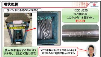
焼き入れ後の組付け作業をした120D J620の金型で作業分解をして時間を調査。③のコアと同じ番号のロッドを探す作業に1番時間が掛かっていることがわかり、調査した結果は「コア本数が多い場合、その中から1本を見つけるのに時間が掛かりますね」との意見があったのでコアの本数によって探す時間がどれくらい変わるのか更に調査してみることにしました。
