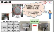
く焼き入れ>同じ硬さのものが何度もこすれると引っ掛かれたような傷や凹凸ができ(かり)ダメージが入るので不良品の原因、金型の破損を防ぐ為、硬度差をたせる処理のです焼き入れ前と後で色が変わりますコア部のみに焼き入れをする為ロッドを外した状態で焼き入れに出します。
