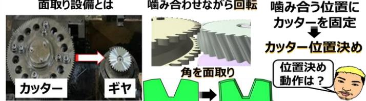
このラインの設備ごとのチョコ停発生件数では、面取り設備が最も多く全体の43%。面取り設備の要因別チョコ停発生件数では、カッター位置決め異常が最も多く全体の67.1%でした。面取り設備とは、カッターをアイドルギヤに噛み合わせながら回転させることで、ギヤの角部を面取りする設備でカッターを噛み合う位置に固定することをカッター位置決めと言います。
