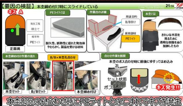
キズA(正面視)の要因の検証で、バックボードを受ける面にPEライトを使用しており、本主締め付け時にビス孔までスライドすることでキズが発生していた。
