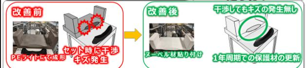
保護材がバックボードに干渉する角度をa・b・cと変え、耐久性、キズ防止性で各保護材を比較しました。結果としてスーパール材とポリエチレン材が高い評価でしたが単面の安いスーパール材を干渉部のバックボード受け面に貼り付けることを対策に決定。
