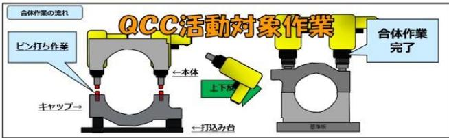
メタルハウジングはキャップと本体で構成。面、穴あけ、タップ加工後、キャップを打ち込み台にセットし、エアハンマーで接続用ピンを打ち込み、本体をキャップにはめ合わせボルトで固定、最後にホーリング加工を行い完了。このピン打ち作業が今回の対象作業です。
