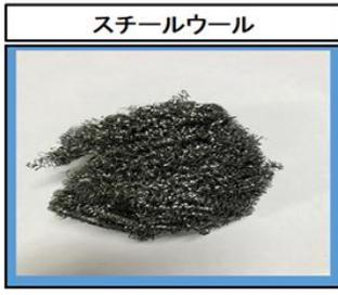
フィルターの取付け位置は、水槽内の3カ所を挙げ、取り付け位置評価表で評価した所、「水が水槽に入る前」に決定。次に、フィルターの選定では、4種類のフィルターを実際に取り付けて、選定表で評価した所、「スチールウール」を採用する事にした。また、GDの中でボックス状にしてその中にフィルターを設置する案を採用する事に。
