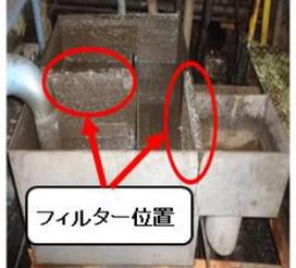
フィルター(は2箇所設置し、交換時のゴミの進入を防止
