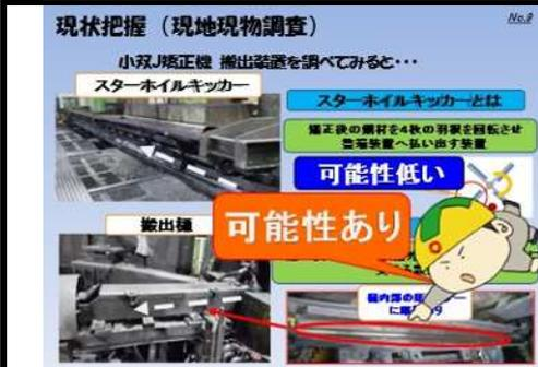
現地にて、搬出側でキズが入りそうな搬出装置を調べてみたところ、スターホイールキッカーは破損、摩耗箇所もなく、過去のキズ発生からの対策で、鋼材との接地面は樹脂製に変更されており、キッカー一部の点検を1つ1つ行い維持管理が出来ることから可能性は低いと判断しました。搬出樋内部にはキズを防止するための床ライナーが取付られていますが摩耗が激しく、可能性有りです！搬出樋内部でキズが入っている可能性が高いと判断し、さらに詳しく調査しました。
