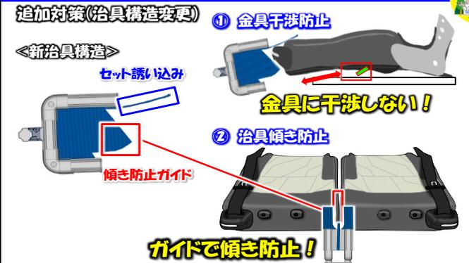
① 治具中央のガイドを背もたれに差し込み、傾きを抑制 ② 嵌め込み構造により金具の干渉防止を図り持ち上げナシ! 位置合わせナシ! ラクに一発セットできる らくらく治具の完成!
