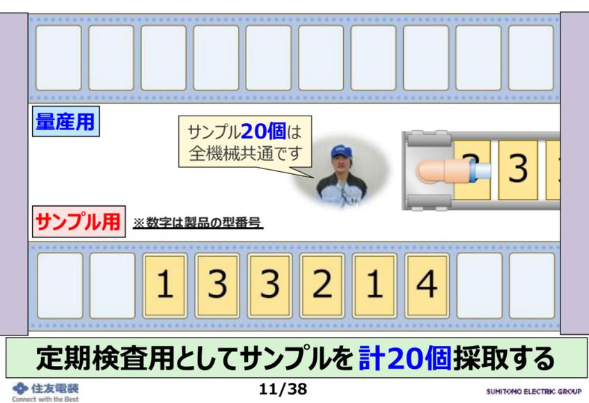
サンプル採取時の梱包機の動作（アニメーション）です。梱包機を上から見た図で、数字は製品の型番を表しています。この様に、設定数20個に到達するまで自動で投入されます。又、サンプル20個は全機械共通となっています。
