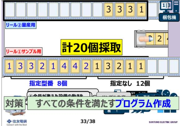
改善した新サンプル採取モードです。必要な型番はサンプル採取用に投入していき、必要数以上の物は通常生産用へ投入する様変更できました。さらに必要数が揃うと残りの型番指定無しの12個をサンプル採取用に投入できるよう改善。必要な数だけを採取できる為、選別するムダ、再採取のムダ、製品廃却のムダがなくなりました。
