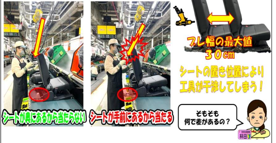
まずは一つ目の要因を現地現物で検証開始。シートが手前があると背裏フック締付け時に締付け工具の導線上にリアバックがあり、締付工具とカバーが干渉キズに繋がっていました。シートの置き位置のブレ幅を計測すると最大30cmもある事が判明。
