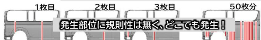
スジの発生部位を確認するためチェックシートを作成し調査を実施。生産時にはね出されたパネルを1枚ずつ確認していくと、パネル毎で発生部位にバラツキがあり、どの部分にでも発生していることがわかりました。
