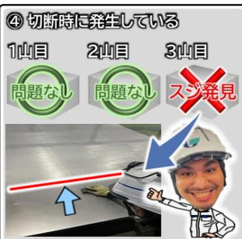
重要要因①の設備ローラー平行度のズレ、②の金型タンカシリンダー破損による成形不良、③のロボット搬送時の周辺設備への干渉を順次調査をしましたが、問題となる箇所はありませんでした。④の切断時に発生では1ロット分山ごとに選別したところ、3山目にスジを発見し、切断材の時点で発生していることがわかりました。
