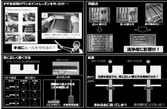
ギザ串をケースへ収納時は、凹凸部分が上向きになるように周知。本当にルールを守れるかが懸念されます。上向きに正しい置き方をすれば、洗浄後の製品間隔は良いですが、誤った置き方をすると、清潔度に影響が。そこで、串に溝を追加し、ブラケットにハマるようにしました。試作品にて問題が出ないかの検証も行いました。結果、溝をつける前は、串は自由に回ってしまいましたが、溝にハマることで、串の位置を固定でき、正しい位置をキープできます。
