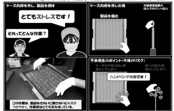
検査時は、洗浄ケース内枠を外して製品を倒しますが、この作業はきれいに倒さないとキズがつきやすく、まさにストレス作業。作業者はとても気を使って作業しています。その後は製品を掴みマガジンへ投入しますが、ここでの不良発生ポイントも、製品に作業者が触れる行為です。
