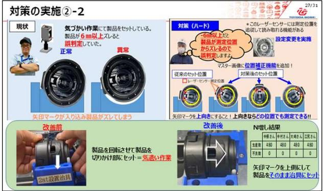
現状では、決められた位置に製品をセットしていた為、気遣い作業になっており、ハード対策として、マスター画像に位置補正機能を追加する事で、どの位置でも測定が可能に。ただし生技より、-6ミリの製品が入り込み状態では、測定不可なので、それを禁止するよう言われ、ソフト対策として、製品の矢印マークを治具側面に合わせるのではなく、製品の矢印マークを上側にセットすれば簡単に位置決めでき、気遣い作業もなく対策完了出来ました。
