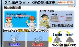
メーカーの推奨で使用しているとのこと 立ち上げ時は今の製品よりも小さい製品をショット しており1ミリ粒だけだと製品にあるくぼみや段差に 粒が入っていかずスケールが残ってしまいます。 そこで0.6ミリの、小さい粒を混合させ使用。
