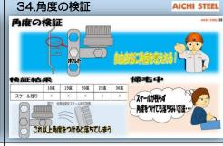
治具はボルト止めによって固定されているので自由 に角度を変えれます
