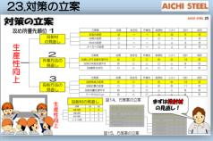
3つの攻め所に対しメンバー全員で沢山の方策案を 出し合い評価した結果、粒度の変更、治具にかける 数を増やす、投射角度の変更に決まり
