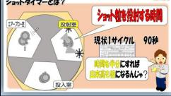
投射室にて材料にショット粒を投射する時間のこと をいいモニターにて簡単に調整が出来ます。 現状は90秒に設定されており 投射する時間が短くなれば出来高向上に繋がるので はないか?とおもいました。
