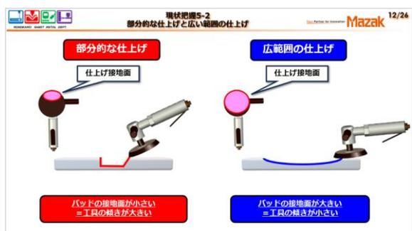
ここで先ほどから出ている部分的な仕上げと広範囲での仕上げについて説明します。部分的な仕上げは仕上げ接地面が小さく工具の傾きが大きい事が分かります。広範囲の仕上げとは仕上げ接地面が大きく工具の傾きが小さくなる仕上げです。
