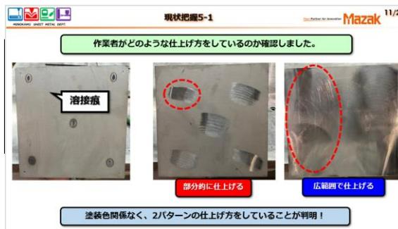
作業者がどのような仕上げ方をしているのが確認しました。すると部分的に仕上げる作業者と広範囲で仕上げをしている作業者がおり、塗装色関係なく1パターンの仕上げ方をしていることが判明しました。
