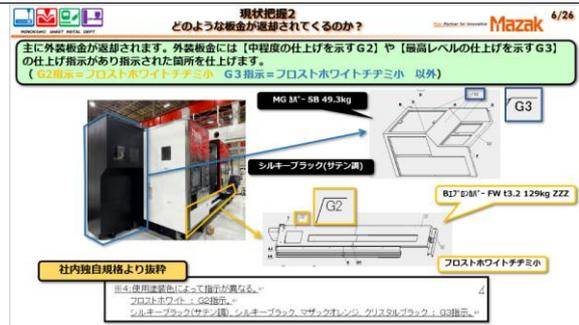
どのような板金が返却されてくるのかと言うと、それは主に外装板金です。外装板金には【中程度の仕上げを示すG2】や【最高レベルの仕上げを示すG3】の仕上げ指示があり指示された箇所を仕上げます。(G2指示=フロストホワイトチチミ小、G3指示=フロストホワイトチチミ小 以外)
