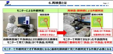
再検査について説明します。自動検査機で撮影された画像をモニターで見て、良品か不良品かを判定しますが、モニターでは外観判定できなかった不良箇所がある場合顕微鏡で基板を見て良品か不良品を判定する作業を再検査といいます。
