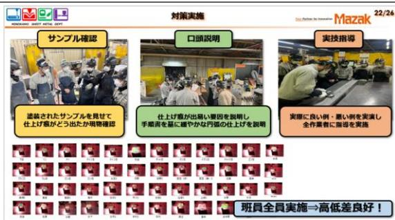
作業者にサンプルを見せ、仕上げ痕がどう出たかを確認してもらいました。次に仕上げ痕が出やすい要因を説明し手順書を基に緩やかな円弧の仕上げをするように口頭説明をした後実際に良い例と悪い例の実技指導を行いました。その後、班員全員にサンプルワークを仕上げてもらい、高低差を測定しました。結果は全て高低差良好でした。
