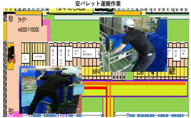
空パレット運搬作業の流れとしまして、ライン外作業者が空パレット置き場から、台車に乗った空パレットを運搬し、AGV受け渡しストアへ空パレットを投入となっています。
