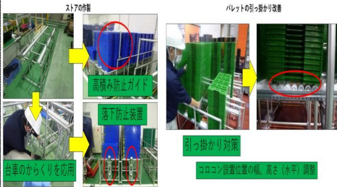
台車への乗せ換えをスムーズに行う為、こちらもコロコンを採用してストアを作製。高積み防止ガイドの設置と台車のからくり機構を応用した落下防止装置の作製により安全性も向上されました。
