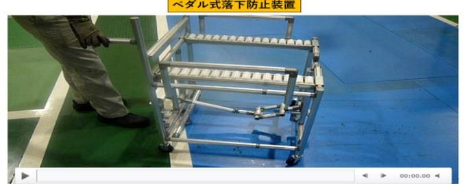
台車とペダル式落下防止装置は写真のようになっており、足元で簡単に落下防止を出し入れでき、運搬時は落下防止オンパレット投入時は落下防止オフに出来るようになりました。
