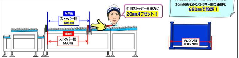
角パイプ測定結果より最大幅670mmから10mm余裕を見て、ストッパー間の距離を680mmで設定し、中間ストッパーを後方に20mmオフセット実施。
