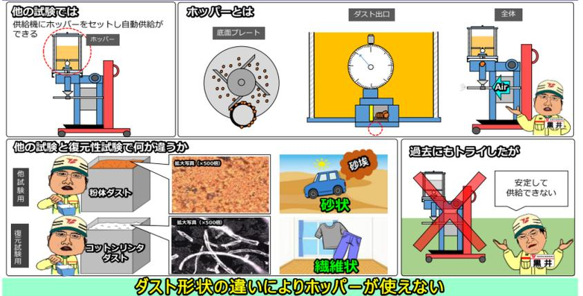
他試験では、ホッパーという物と供給機を組合せ自動供給が出来ていますが、復元性試験ではホッパーを使うと安定しない為手動で供給しています。他の試験との違いはダストです。他の試験は砂状のダストですが、復元性試験は衣類等の埃を模擬した繊維状のコットンリントダストという物になります。
