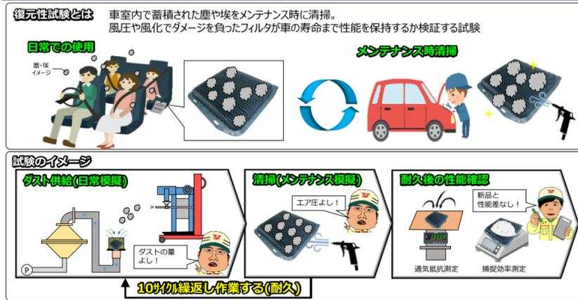
復元性試験とは、日常使用で蓄積された埃などをメンテナンス時に清掃。それらを繰り返し行い風圧や風化でダメージを負ったフィルタが車の寿命まで性能を保持するか検証する試験です。実際は、埃などの蓄積を模擬したダスト供給と清掃を10サイクル繰り返し耐久し、新品と耐久品で性能比較・判定する試験です。
