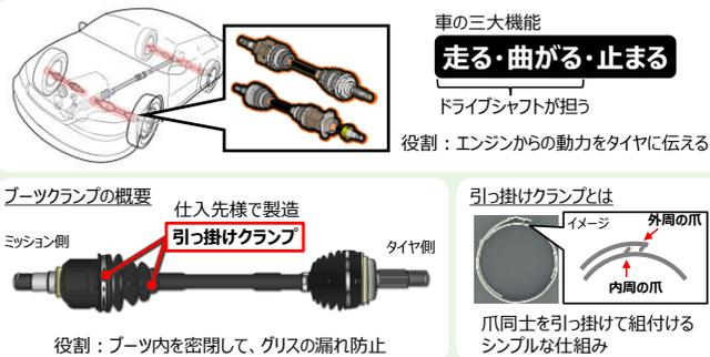
ドライブシャフトは車の三大機能のうち、走る・曲がる を担いエンジンの動力をタイヤへ伝える役割があります。今回のテーマの引っかけクランプは、ドライブシャフトのミッション側のブーツに使用されます。役割としてブーツ内を密閉し、グリスが漏れるのを防止します。仕組みとしては、爪同士を引掛け組付けるシンプルな製品です。
