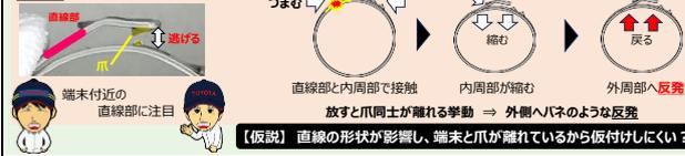
要因解析にて特性要因図をメンバーと作成し「クランプの反発方向が内周に沿っていない」をなぜなぜで確認。すると「外周部端末付近に直線部がある」が要因にありました。要因調査で端末付近の直線部に注目し、悪さ加減を推察。直線部が影響し、端末と爪が離れ仮付けしにくいのではないかと仮説を立てました。
