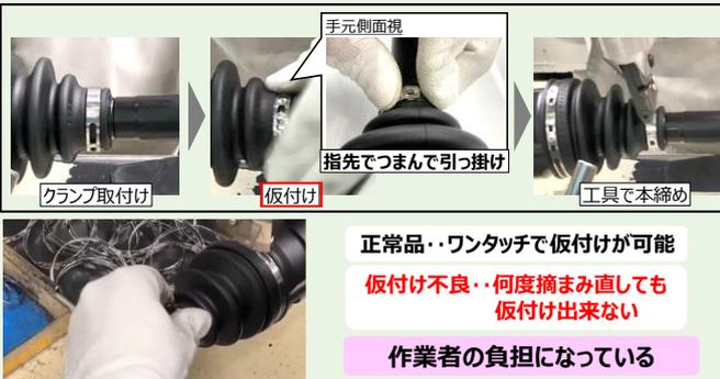
ブーツ小クランプ締め付け工程の流れとしては初めにクランプを取付け指で摘まんで仮付けを行い、最後にクランパーにて本締めを行っています。正常品ではワンタッチで仮付けが行なえるのに対して仮付け不良品ではクランプを何度摘まみ直しても仮付けができず作業者への負担が大きくなっています。
