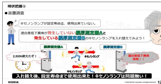
キセノンランプ個体の異常有無を調査する為、適合度低下異常発生装置から正常稼働装置へキセノンランプを入れ替えて検証を行いました。結果、異常発生装置では使用不可と判定されたキセノンランプが、正常装置に取り付け後は、設定寿命まで使用可能となりました。つまり、キセノンランプ個体には、問題無い事が判明しました。
