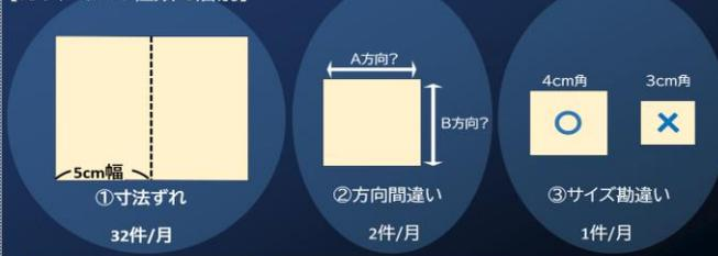
燃料電池膜の寸法ずれによるカットミスが多く発生している
