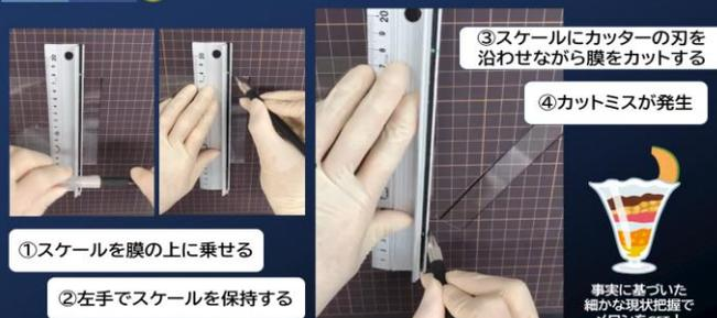
スケールを膜の上に乗せ左手でスケールを保持します。スケールにカッターの刃を沿わせながらカット。その際、このようにカッターの刃がマーキングから外れカットミスが発生している事がわかります。両チーム混合で進めたことで物性強度コミュニケーションレベルが向上。更に現状把握をクリアしたことでメロンをゲットしました。
