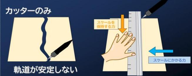
要因調査に入る前に、「スケールにかかる力が大きい」を主要因にした根拠を説明します。スケールがない状態でカットするとカッターの軌道が安定せず、真っすぐカットする事ができません。これを踏まえ、スケールを使用してカットすると軌道は安定しますが、スケールにかかる力がスケールを保持する力より大きくなると、カッターの軌道が安定せず寸法通りにカットができていないと考えました。
