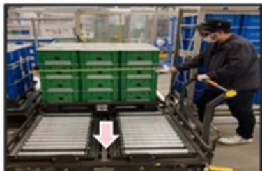
ずり込み作業とは、シュートから台車へ物をローラーで滑らせながら移動させること
