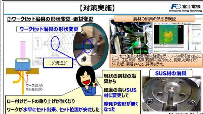
セット治具のニゲ溝を追加する事により、ロー付けのビードの乗り上げをなくし、ワークが水平にセット出来、安定しました。メーカーより溶接の通例でワーク台の接地面を銅素材で作られていることから、生産技術部と品質保証部の協力をいただき、熱引きの検証を行い溶接時の加熱でワークに影響がないか評価を行いました。問題ない結果を確認後、素材を硬度の高いSUS材に変更して、摩擦や変形の影響を無くしました。
