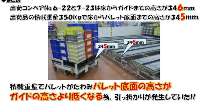
調査結果まとめ、出荷コンベアNo6-22と7-23は床からガイドまでの高さが346mm。出荷商品の積載重量350kgで床からパレット底面までの高さが345mm。積載重量でパレットがたわみパレット底面の高さがガイドの高さより低くなる為、引っ掛かりが発生していることがわかりました。
