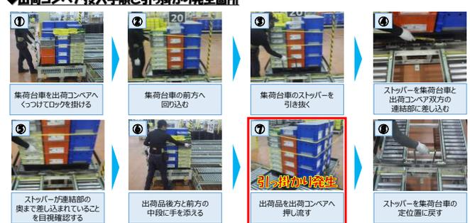
次に出荷コンベアの投入手順と引っ掛かり発生箇所ですが、①集荷台車を出荷コンベアへくっつけてロック②集荷台車の前方へ回り込む③集荷台車のストッパーを引き抜く④ストッパーを集荷台車と出荷コンベア双方の連結部に差し込む⑤ストッパーが連結部の奥まで差し込まれていることを目視確認⑥出荷品後方と前方の中段に手を添える⑦出荷品を出荷コンベアへ押し流す⑧ストッパーを集荷台車の定位に戻す。という流れになっており、手順⑦の出荷品を出荷コンベアへ押し流すところで引っ掛かりが発生しています。
