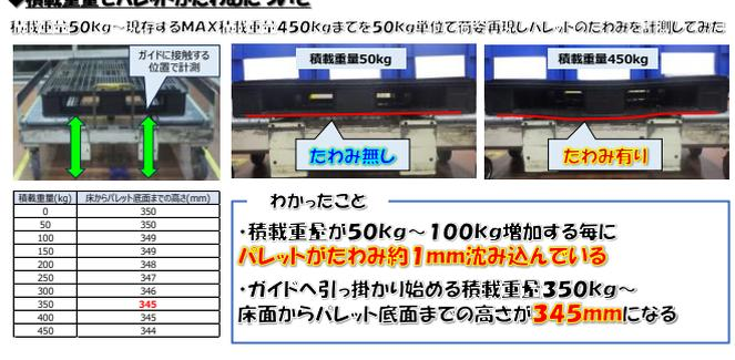
次に積載重量でパレットがたわむについてですが、積載重量50kg~現存するMAX積載重量450kgまでを50kg単位で荷姿再現しパレットのたわみを計測してみました。積載重量50kg~100kg増加する毎にパレットが約1mmたわむことやガイドへ引っ掛かりが発生し始める積載重量350kg~床面までの高さが345mmになることがわかりました。
