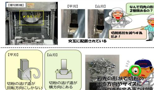
切断機で使用されているメタルソーと呼ばれる刃先には平刃と山刃が交互に配置されており、これは切断時の抵抗を減らす為です。平刃は、切粉の逃げ道は回転方向に限られる。山刃は、切断時に切粉は横方向に逃げる。刃先の形状によって切粉の飛び方向やサイズにバラつきがあることが分かりました。
