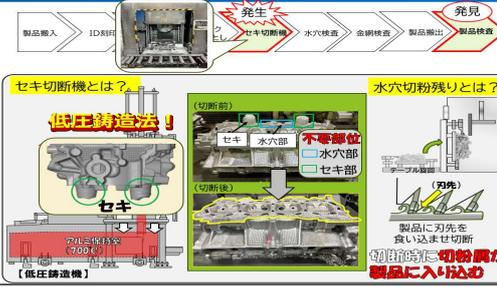
今回問題となっている工程はセキ切断機で問題が発生し製品検査時に発見されます。セキ切断機とは私たちのラインでは低圧鋳造機と呼ばれる設備に製品の金型を取り付けて造形します。鋳造方法はアルミ保持室へ低圧のエアーを加える事でアルミを押し上げ、金型内に充填し、その通り道となるものがセキと呼ばれる。そのセキと水穴不要部位を切断機にて切断していきます。水穴切粉残りとは、製品をメタルソーと呼ばれる刃で切断した際に水穴空洞部に切粉が入り込んでしまいます。
