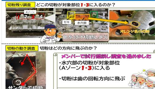
どこの部位の切粉が入るかを調査しました。どうすれば切粉進入をとらえられるかメンバーで話し合い「セキ部、水穴部に色を付ければ切粉の動きが分かるかも!」と意見が出たので調査した所、色を付けた水穴部の切粉が水穴空洞部に入る事が判明。次に切断した切粉はこの方向に飛ぶのかを調査し実際にサンダーを使用して鉄のアンクルを切ってみると切粉は刃の回転方向に飛ぶ事が判明しました。
