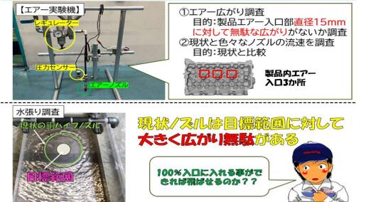
エア実験機を使用しノズルの流速と広がりを調査しました。製品のエア入口直径15mmに対して無駄な広がりをしていないか、色々なノズルの流速を比較し、現状ノズルは目標範囲に対して大きく広がり、無駄がある事が分りました。
