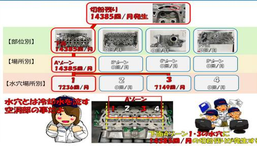
切粉残りが月に14385回発生しており部位別、場所別、水穴場所別で層別したところ全てが下面の水穴①、③に切粉残りが発生。水穴とは、冷却水を流す空洞部で、この①、③が問題点となりました。
