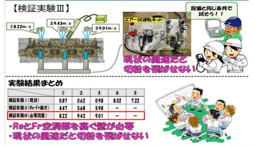
検証実験3切粉を飛ばすに必要な流速の測定を、設備課さん協力のもとエア一試運転キットを使用したところ現状の風速だと、切粉を飛ばす事が出来ないという事が分りました。3つの実験結果のまとめとして、Re,Fr,をふさぐ壁が必要な事と現状の風速だと切粉を飛ばせない、という結果になり仮説①のRe,Fr,からエアが抜けすぎるが正解でした。
