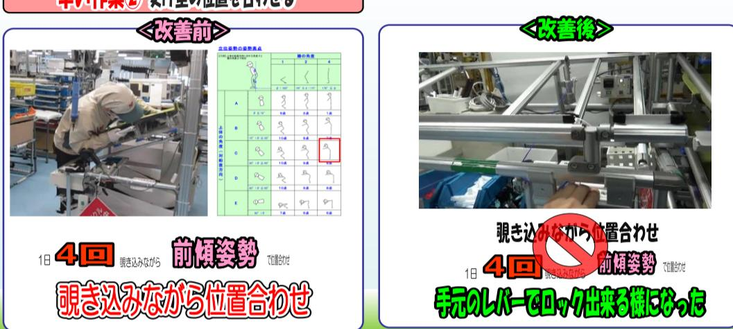
前傾姿勢で受け型を除きながら位置決めピンを挿入していた作業は、手元のハンドルを操作する事で、ハンドルと位置決めピンが繋がったヒモにより上昇、下降させる事が出来る様になり、覗き込んで位置を確認するという作業を廃止する事が出来ました。
