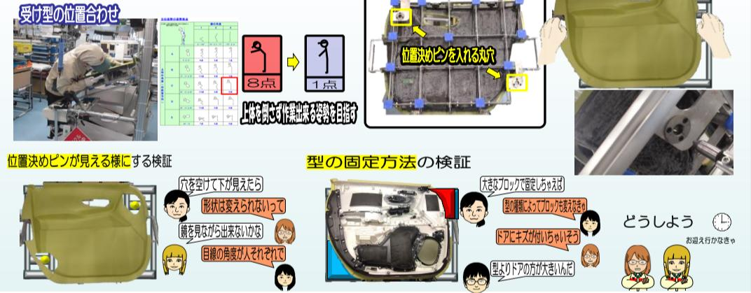
位置決めピンが入れにくいに対して、位置決めピン調査チームは上体を倒さずに型をセットできる姿勢を目指す。型の裏面にある位置決めピンを目視出来る様に型の肉抜きや鏡の反射を使って目視しようとを考えたが、どちらもうまくいかず。位置決めピンに代わる固定方法を試すもドアトリムの形状が型よりも大きく、形がそれぞれ違う為、共通の固定方法を検討するも良い案が出ない状況でした。
