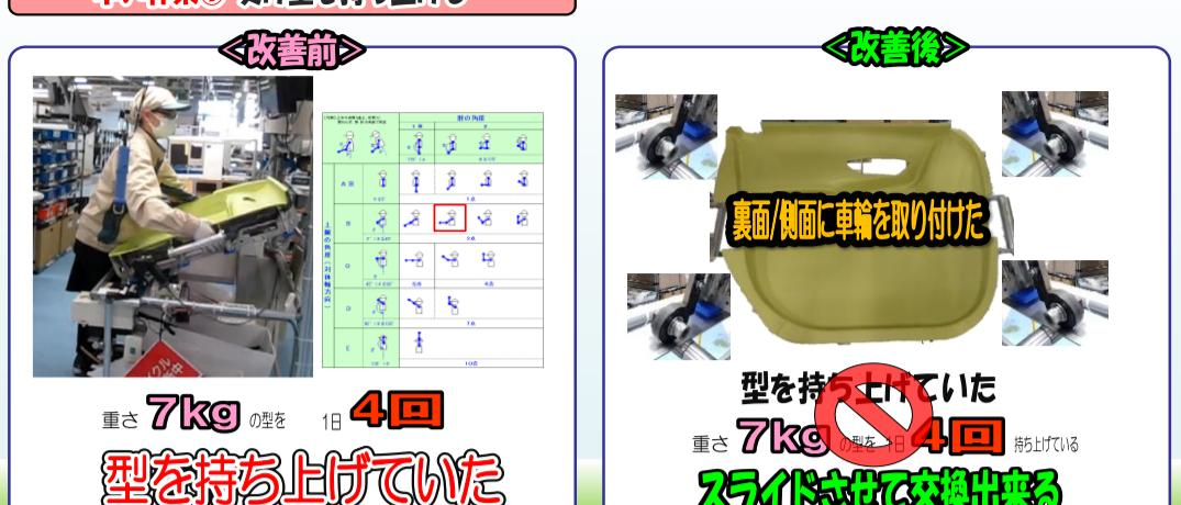
重さ7kgの受け型を1日4回持ち上げていた作業は、受け型にタイヤを取り付けてスライド出来る様にした事で、持ち上げずに片手で簡単に動かす事が出来る様になりました。
