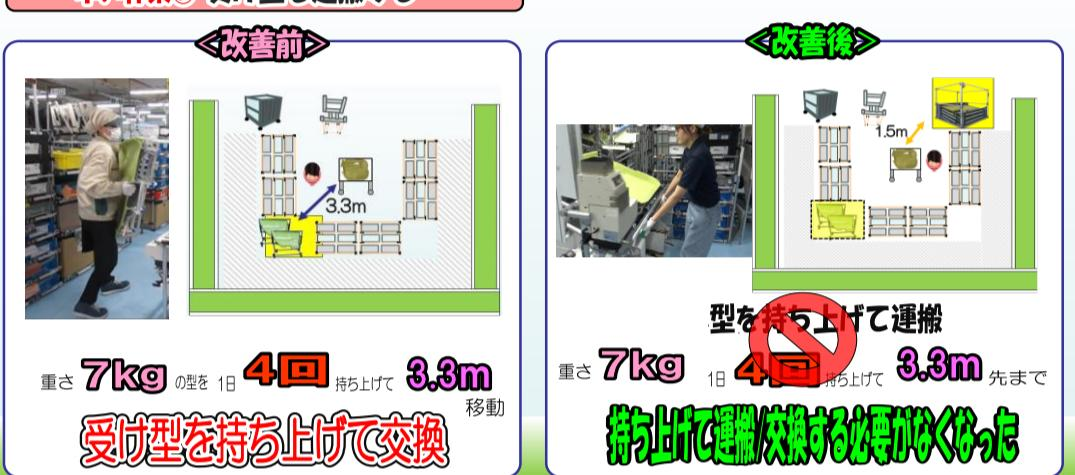
受け型を持ち上げながら型の交換を行っていた作業は、受け型を持ち上げる必要が無くなったり、型のスライド改善と、位置決めピン改善により作業台に乗せたまま型交換が出来る様になりました。子供のおもちゃを応用に作成した型替えラックは上昇下降の操作も、重りの力で操作荷重2キロと女性でも軽々と出来る様になっています。
