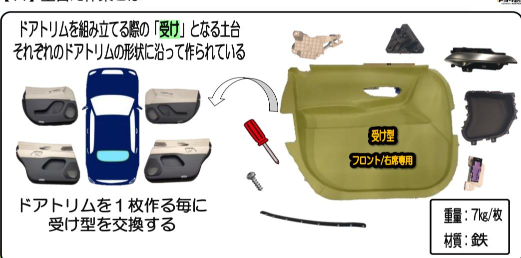
困りごとにある「型替え作業」とは、ドアトリムを組み立てる際の受けとなる土台部分で、それぞれのドアトリムの形状に合わせて作られています。その為、1台のドアトリムを生産するとなると4回の型替えが必要となります。
