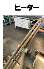
タンク内部の調査を行いました。その結果、鏽や汚れがタンクやヒーターの表面に多く付着していました。調査時、曲損しているヒーターも3本確認された為、取替を行っています。
