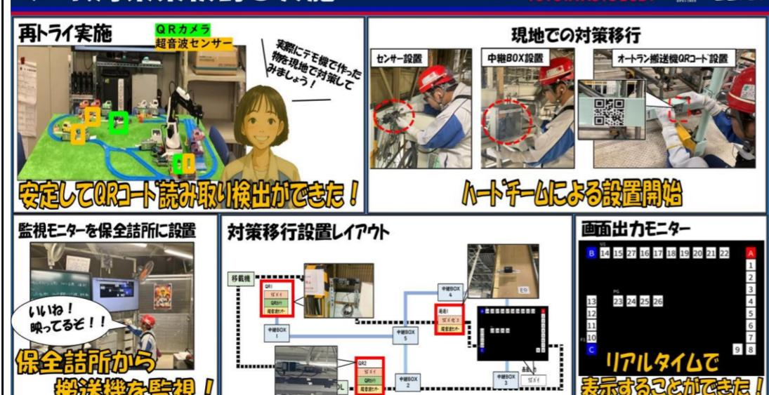
デモ機で再トライした結果、安定してQRコード読み取り検出ができました。そして、ハードチームによる現地での対策移行開始。画面モニターは保全詰所に設置し、詰所から搬送機の監視をすることにしました。対策移行レイアウトの沿って対策をすすめていった結果、リアルタイム表示機能を実装できました。
