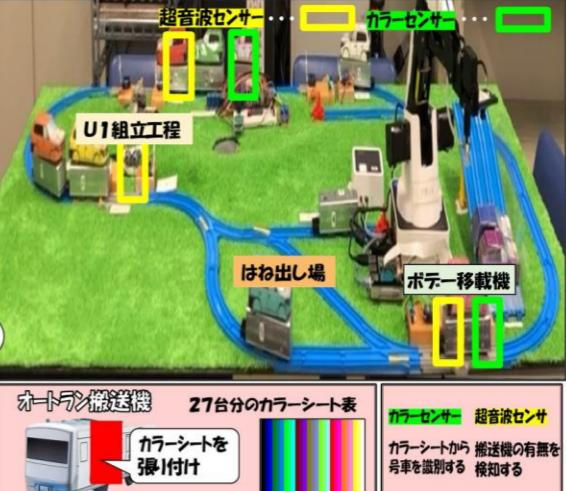
まずは、デモ機の図面を手書きで作成。メンバー全員で、意見を出し合い、試行錯誤を繰り返し、プラレールのデモ機が完成！！オートラン台数の27台分のカラーシートを用意して、号車を判別。超音波センサで、搬送機の有無を検知する物が完成しました。
