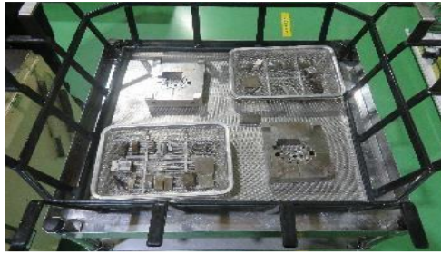
汚れた金型部品（入駒）を洗浄機かごに入れる
